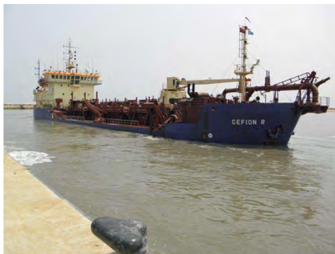
Draga de sucção na bacia do cais dos estaleiros navais de Porto Amboim Suction dredger in the dock of shipyards of Porto Amboim
